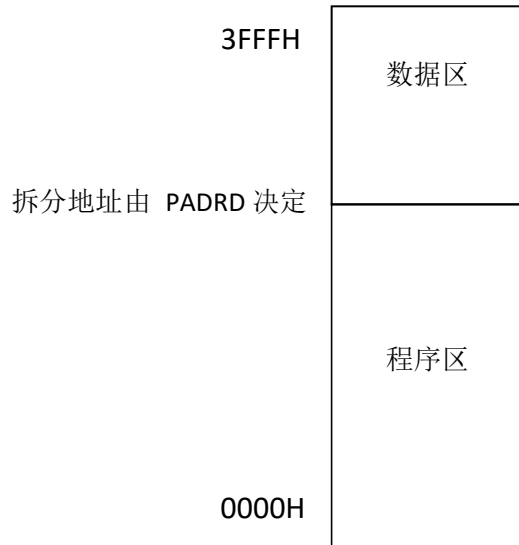
图 7-3-2-1 16K Flash 存储器结构
