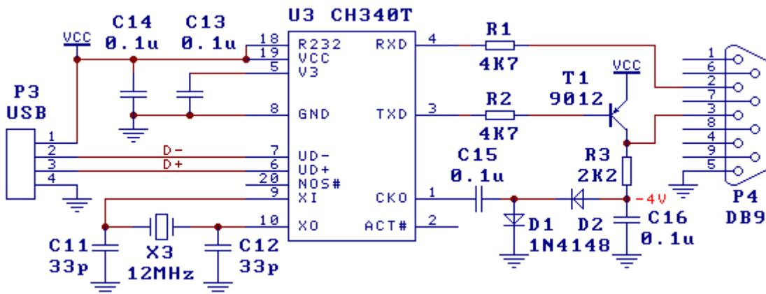
图中也是 USB 转 3 线制 RS232 串口，该电路与 7.2 节的功能相同，只是输出 RS232 信号的电平幅度略低。CH340 的 R232 引脚为高电平，启用了辅助 RS232 功能，只需外加二极管、三极管、电阻和电容就可代替 7.2 节中专用的电平转换电路 U5，所以硬件成本更低。
