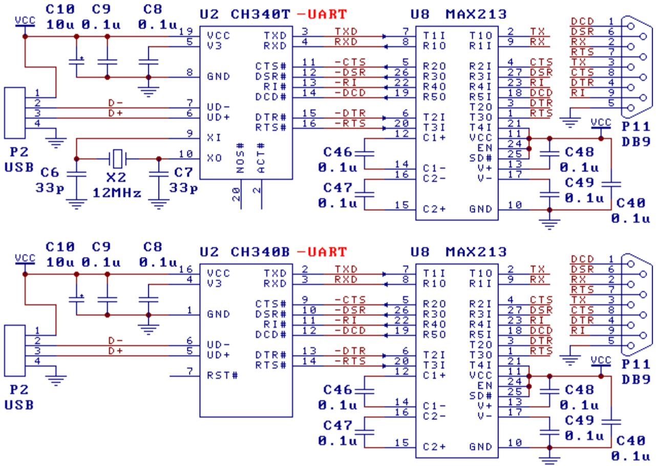
上图是由 CH340T 或 CH340B (或 CH340C) 实现的 USB 转 RS232 串口。CH340 提供了常用的串口信号及 MODEM 信号, 通过电平转换电路 U8 将 TTL 串口转换为 RS232 串口, 端口 P11 是 DB9 插针, 其引脚及功能与计算机的普通 9 针串口相同, U8 的类似型号有 MAX232/ADM232/SP232/MAX231 等。
