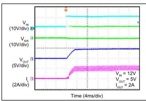
**FIGURE 2-27:** V<sub>IN</sub> Soft Start Turn-On (MIC28512-2).
