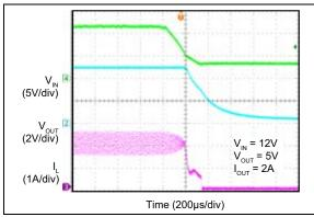
**FIGURE 2-44:** V<sub>IN</sub> Shutdown (MIC28512-1).
