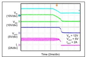
**FIGURE 2-28:** V<sub>IN</sub> Shutdown (MIC28512-2).
