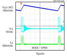
MAX17503 5V OUTPUT, DCM MODE, 25mA LOAD STEADY-STATE SWITCHING WAVEFORMS,
