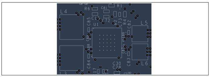
Figure 26 LAYER 7 – GROUND PLANE
