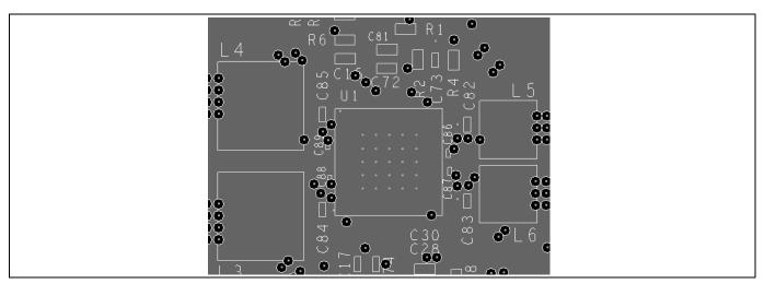
Figure 23 LAYER 4 – GrouND Plane
