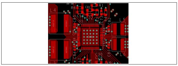
Figure 20 LAYER 1-TOP SIDE COMPONENTS PLUS POWER PLANE
