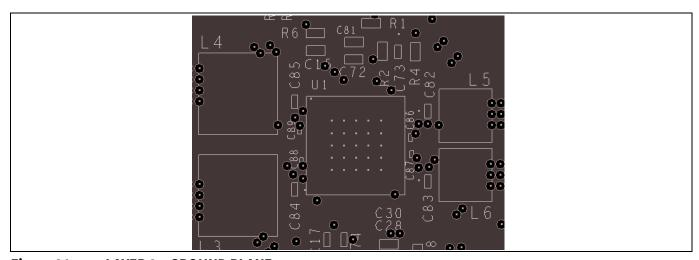
Figure 21 LAYER 2 – GROUND PLANE
