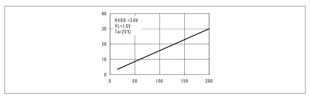
Figure 7-39: Rise Time v.s. Capacitance  $(C_L)$
