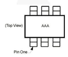
Figure 3. Pin One Orientation Diagram<sup>(1, 2)</sup>
