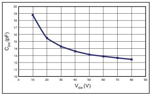
FIGURE 3-1:  $C_{SW(OFF)}$  vs.  $V_{SW}$ .
