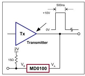
**FIGURE 3-5:** Test Setup for  $T_{ON}$ .
