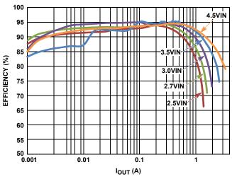
FIGURE 2. ISL91108IINZ EFFICIENCY vs OUTPUT CURRENT
