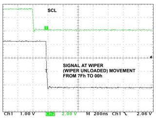
FIGURE 10. LARGE SIGNAL SETTLING TIME
