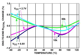
FIGURE 7. END-TO-END R<sub>TOTAL</sub> % CHANGE vs TEMPERATURE
