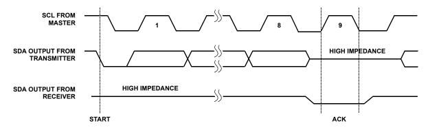
FIGURE 13. ACKNOWLEDGE RESPONSE FROM RECEIVER
