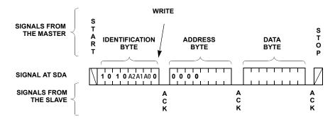
FIGURE 14. BYTE WRITE SEQUENCE
