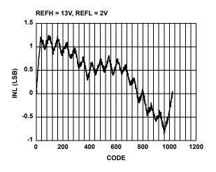
FIGURE 2. INTEGRAL NONLINEARITY ERROR
