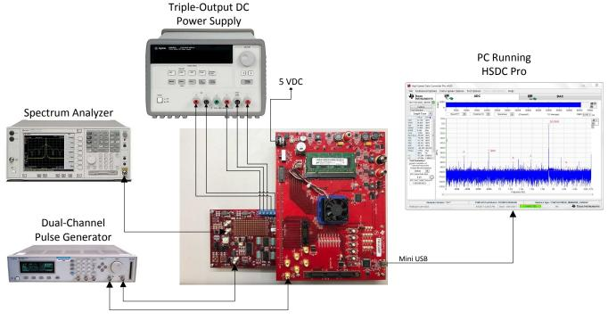
Figure 3. Quick-Start Test Setup
