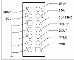
Figure 5: J2 (WV4S) Header Pin Out
